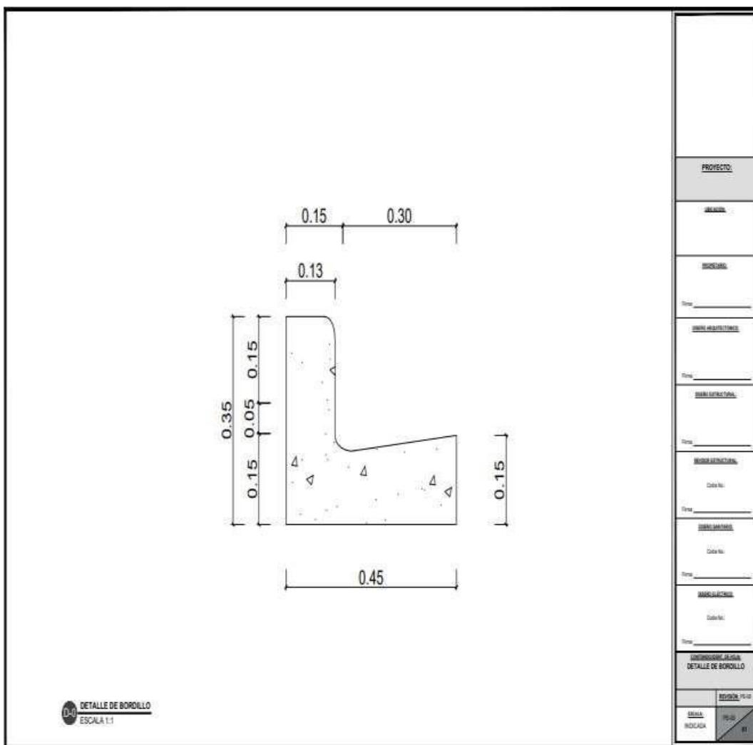
Para los Contenes a construir se elaborarán plantillas tipo que tendrán de respaldo atrás 35 cm y el fondo abajo el pie del contén 45 cm; como batea del contén tendrán 30 cm y de alto entre el fondo y la terminación de batea tendrá 15 cm. La batea tendrá una ligera inclinación para canalizar las aguas de 5 cm, que se integraran a los 30 cm de la batea; desde ahí hasta el tope final tendrá 15 cm, con radios de giro en los extremos de 2.5 cm.
